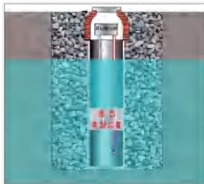
图 2 有换热颗粒型地能采集井
